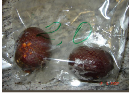
FIG. 3.2 Buritis separados em saco plástico para receber uma dose de 2,0 kGy de radiação gama.
