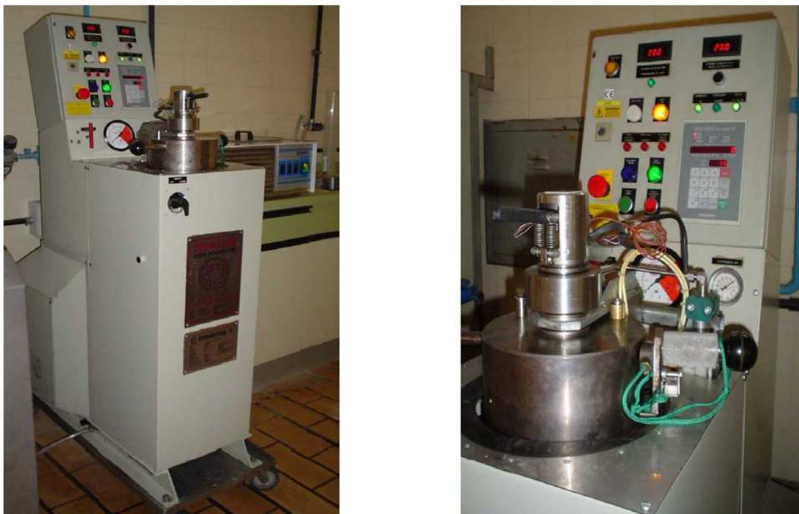
Figura 8. Equipamento de Alta Pressão Hidrostática Stansted Fluid Power
