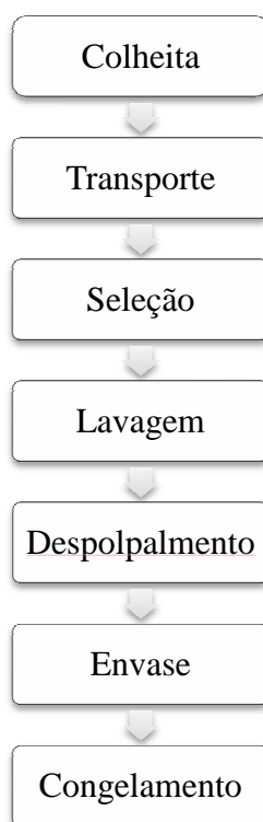
Figura 7. Fluxograma de processamento do cajá
