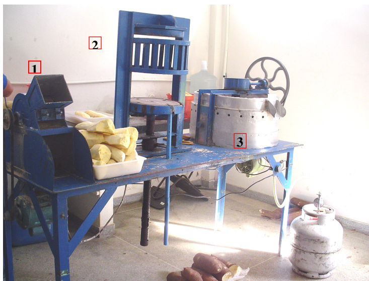
Figura 6. Mini-casa de Farinha. 1) Ralador Rotativo. 2) Prensa manual. 3) Forno com Paleta Rotatória. Foto cedida pela Embrapa CNPMF – Cruz das Almas-Ba.
