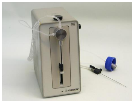
Figura 3. Bomba "Positive Displacement" (bomba seringa). Fonte: Ms4sale (2013).
