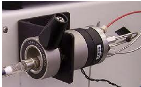
Figura 5. Injetor Rheodyne manual. Fonte: Laserchrom (2013).
