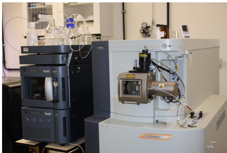
Figura 16. Sistema CLUE-TOF utilizado: UPLC Acquity-Synapt, Waters. Fonte: Arquivo pessoal.
